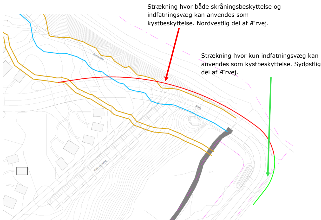
Figur 12: Illustration af potentiel kombination af kystbeskyttelseskoncepter på strækningen, hvor Ærvej er beliggende nærmest kysten og dermed potentielt truet i forbindelse med kystudviklingen. De viste strækninger angiver ikke den faktiske placering af kystbeskyttelsen, der forudsættes etableret på eksisterende landarealer i takt med at kysten rykker tilbage ind i land. (Erosionslinjer er baseret på klimamodel RCP8.5, der ligger til grund for vurderinger af erosion ved Nordals Ferieresort. Der er ikke gennemført en særskilt vurdering af erosionen af Ærvej, hvor klimascenarie RCP4.5 kan tages i betragtning).
