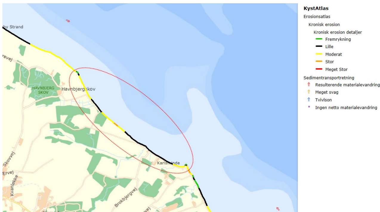
Figur 3-3: Resulterende sedimenttransportretning (røde pile) samt grad af kronisk erosion på kyststrækningen ved projektlokaliteten. [Kystdirektoratets KystAtlas, 2019]. Den røde stiplede linje markerer den såkaldte sedimentcelle.
