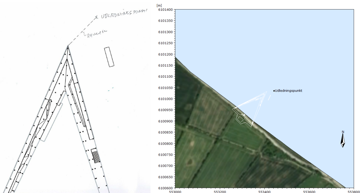
Figur 4-9: Omtrentlig position for udløb fra regnvandsbassin, skitseret fra Hoffman (venstre) og implementeret i modelberegningerne (højre).
