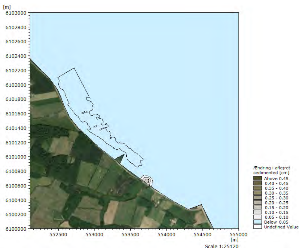
Figur 14-19. Udbredelse og ændring i lagtykkelse af sedimentaflejringer ved et tillæg på 25.000 kg sediment fra overfladeafstrømning fra Nordals Ferieresort til Gildbæk.
