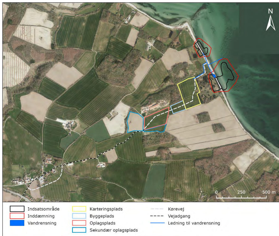
Figur 16-30: Oversigtskort over projektets placering af adgangsvej via offentlig vej for oprensning af Himmark Strand. Internt i projektområde er der markeret en kørevej, der tilsluttes adgangsvejen.
