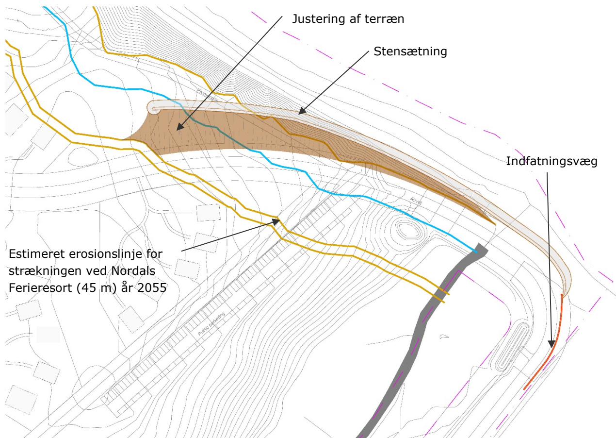
Figur 5-9: Skitse af mulig kystbeskyttelse af den kystnære del af Ærvej og Karlsmindevej ved fuld udbygning i år 2055. Indfatningsvæg (rød linje), stenskråning (lysegrå), areal der terrænreguleres bag stensætning (brun flade). Erosionslinje estimeret for strækningen ud for Nordals Ferieresort (45 m kysttilbagerykning) for år 2055 er angivet. Der er ikke gennemført en særskilt vurdering af erosionen af Ærvej, hvor klimascenarie RCP4.5 kan tages i betragtning).
