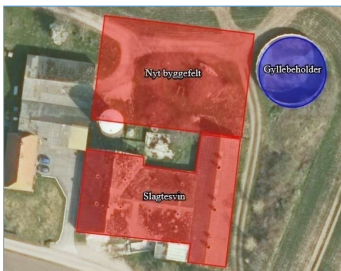
Figur 11: Genopførsel af stald på eksisterende fundament og nyt byggefelt ved eksisterende stald.
