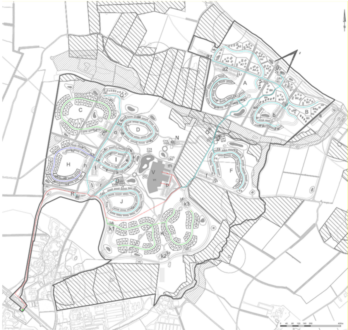
Figur 3: Nordals Ferieresort projektområde (udsnit kort 10 4) – med tilhørende fjernvarme ledningsnet startende med rød fordelingsledning fra Majløkke pumpebygværk. Fjernvarmeledningerne med stik følger sammen med de øvrige forsyninger i vej- og stisystemet
