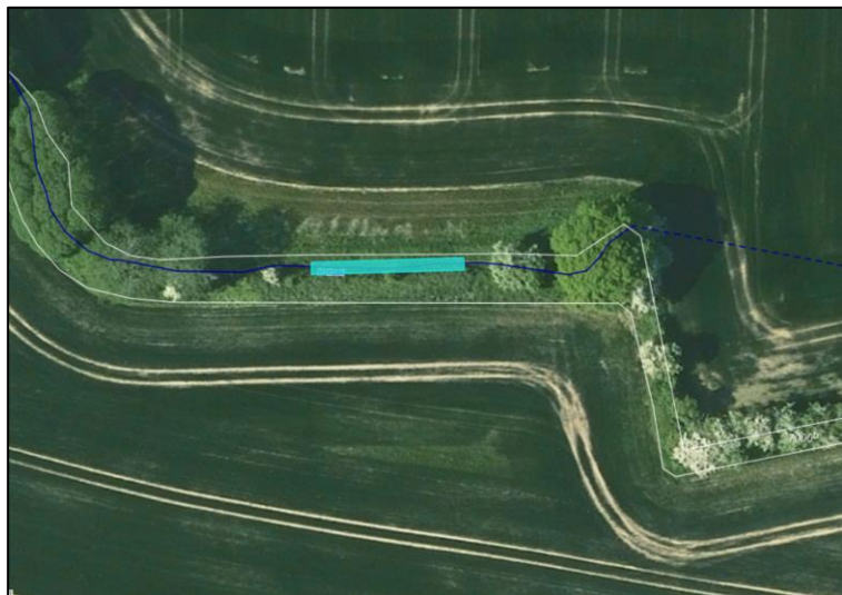
Figur 1. Sandfanget placeres lige nedstrøms for den rørlagte delstrækning med en dimension på 2 x 25 m.
