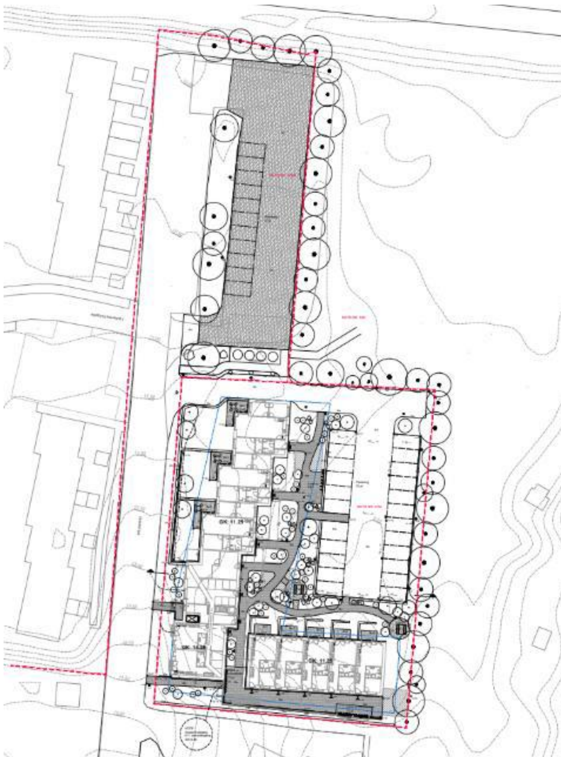
Figur 1: Det fulde overblik over hele arealet for byggeprojektet. De relevante steder for denne tilladelse er parkeringspladsen i den østlige del, hvor man genindbygger PFAS-forurenet. Der vil også foregå arbejde i den nordlige, hvor man genindbygger områdeklassificeret jord under vej arealer.
