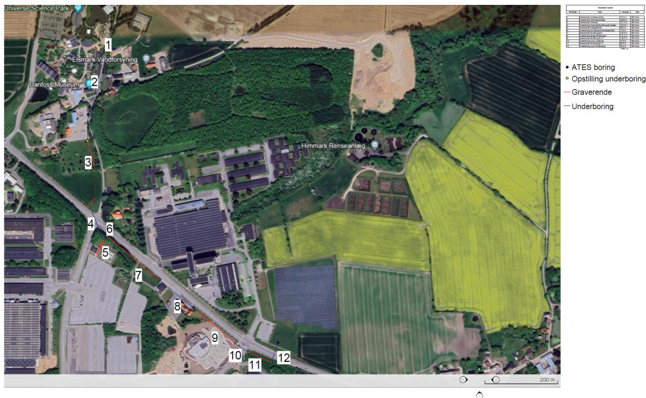
Figur 3. Figur 3 viser boringsplaceringer med blå punkter, samt hvordan traceet forløb påtænkes, med de røde linjer.
