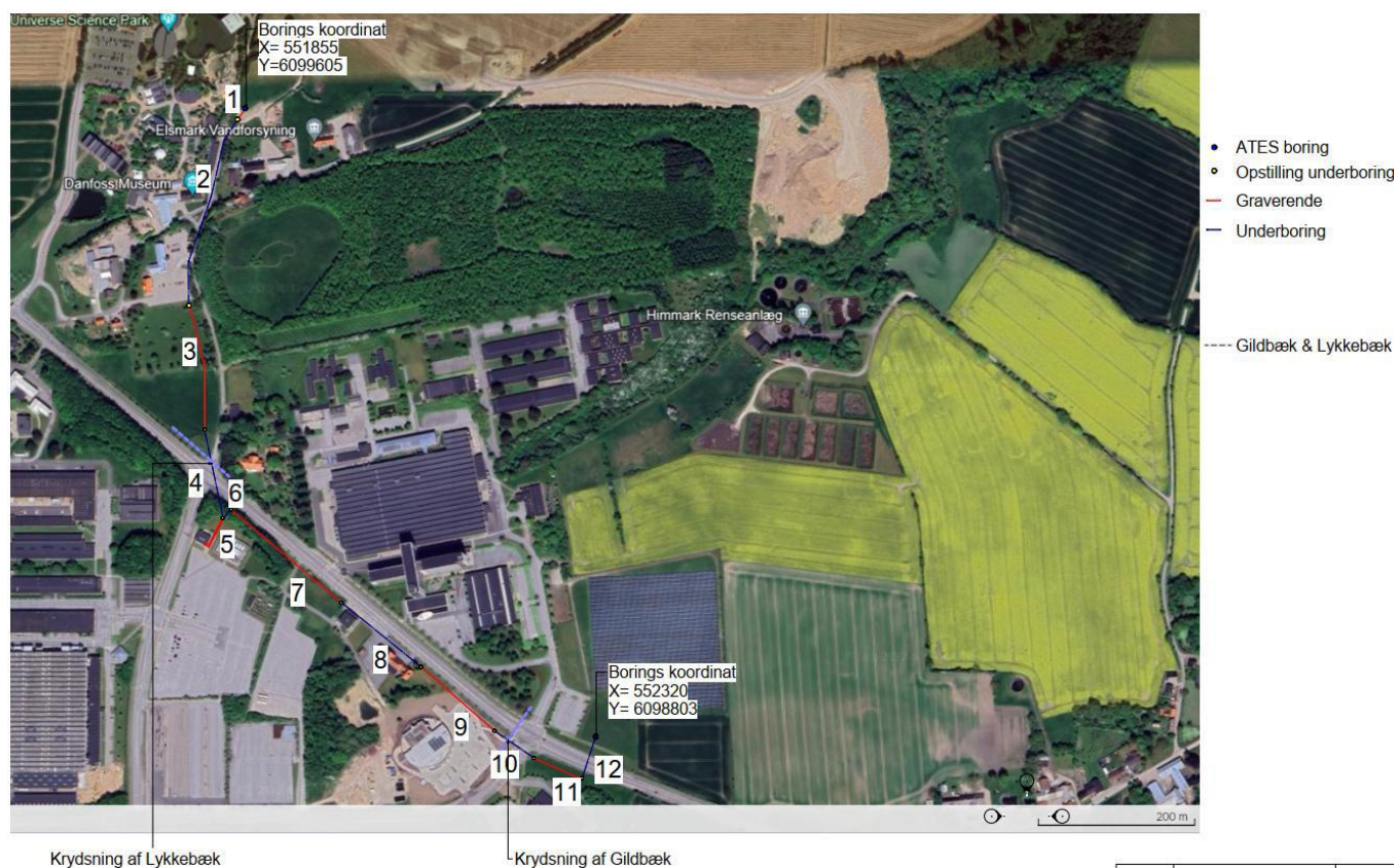
Figur 2. Oversigtskort – Placering af grundvandsanlæg ved Danfoss i Nordborg. Boringer er angivet med blå prik og koordinater, og rørtrace er angivet med blå (styrede underboringer) og røde (traditionel graverende) streger.
