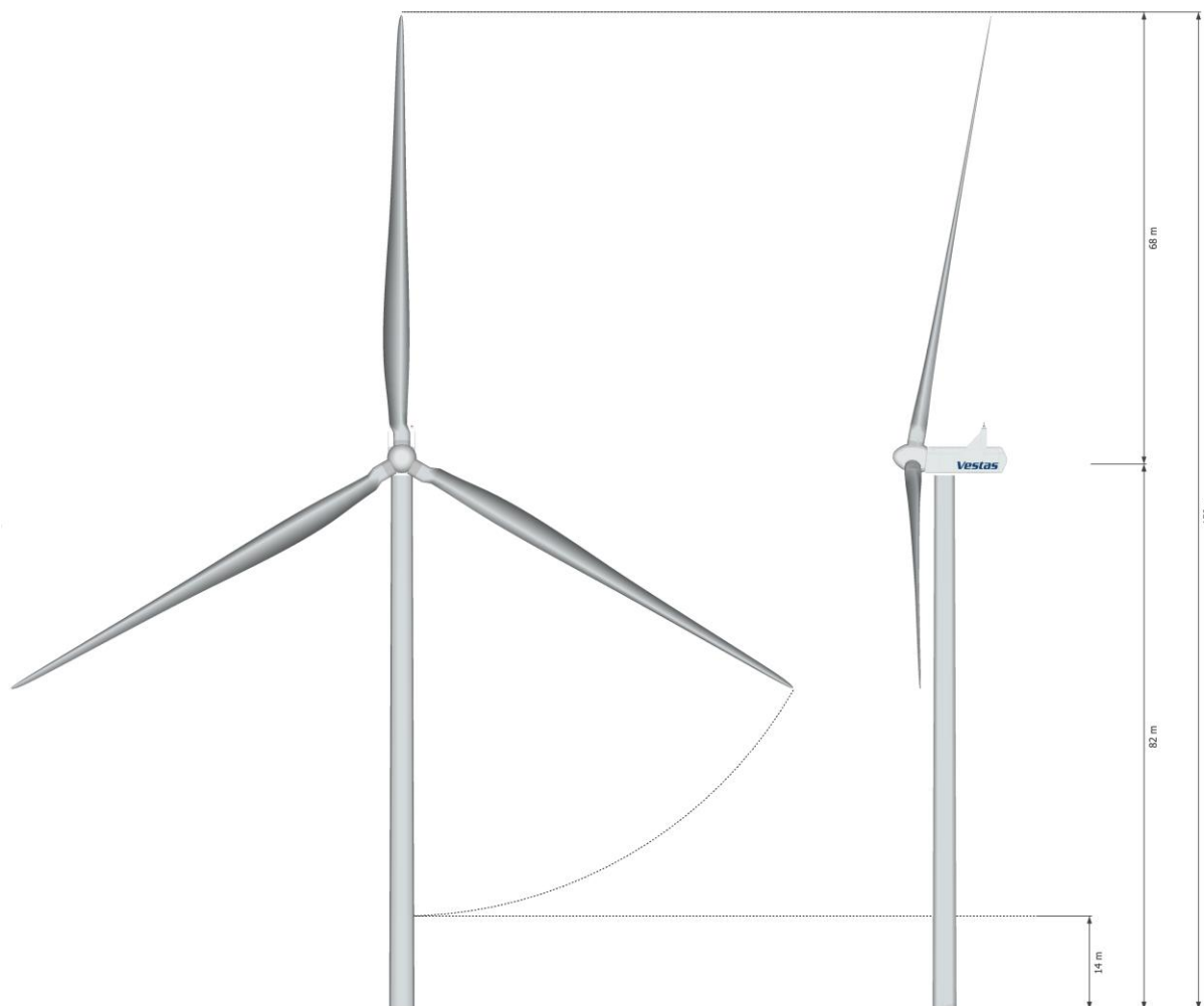
Figur 2. Princip tegning af vindmølle type Vestas V136 med angivelse af navhøjde (82 m), rotordiameter (136 m) og totalhøjde (150 m).
