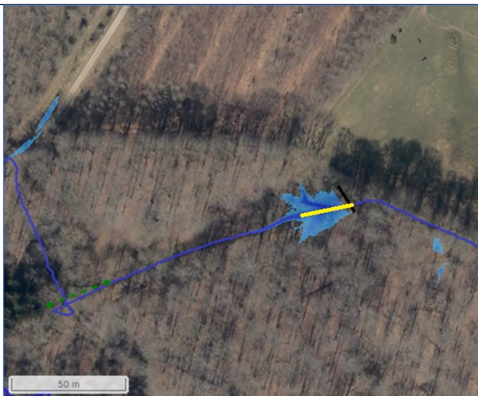
Figur B4.3a – Effektområde for H3 på 0,34 ha. som er afbilledet som den store blå polygon i rød cirkel. Effektområde er synliggjort i SCALGO ved en skybrudshændelse og med tilkastning af ca. 30 meter grøft, gul streg. Billedet er fra SCLAGO.
