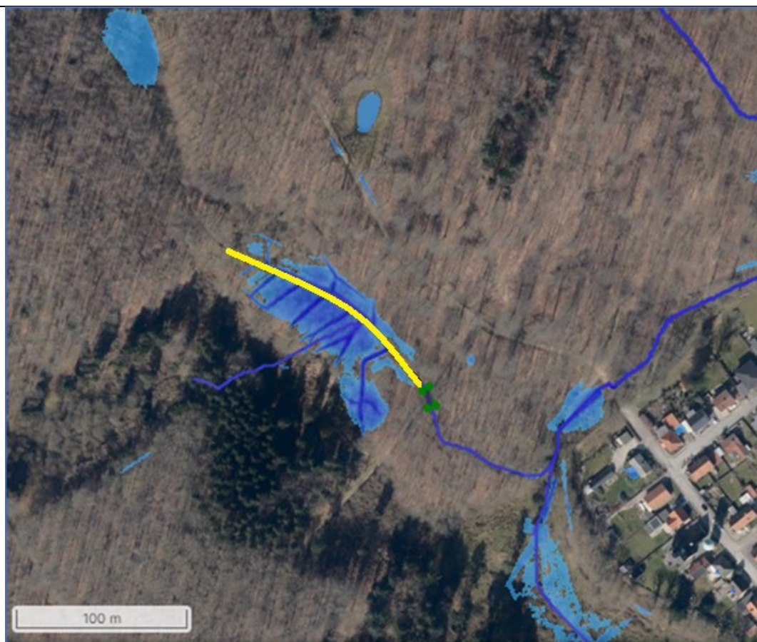
Figur B4.5a – Effektområde for H5 på 0,47 ha. som er afbilledet med den blå polygon ved et skybrud. Den gule streg er strækningen på op til 130 meter, hvor grøften tilkastes. De grønne prikker viser en rørunderføring. Billedet er fra SCLAGO.
