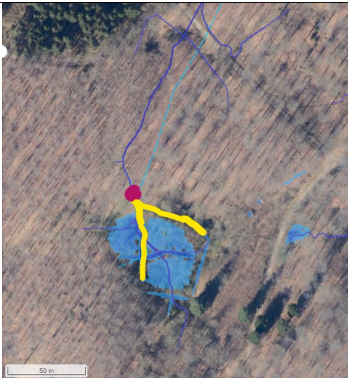
Figur B4.11b – Effektområde for H11 ved skybrud. Arealet dækker 0,34 ha. Kisten afproppes (lilla prik). Ca. 110 meter fordelt på de to grøfter blive tilkastedet, for at opnå effekt ved en skybrudshændelse. Den stiplede lyseblå linje viser det §3 beskyttede vandløb, som i dag er rørlagt. Billede fra SCALGO.
