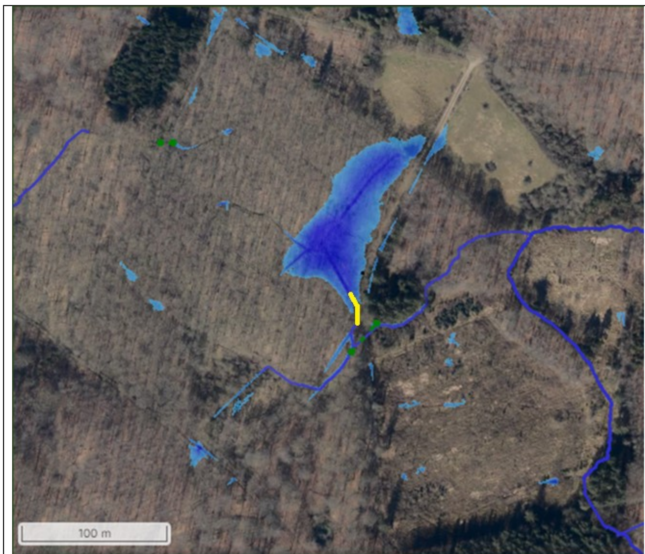
Figur 4.2b – Effektområde for H2 ved nedbørshændelse på 100 mm, vist som den store blå polygon på 0,44 ha. og grøft mod syd tilkastes afbilledet med en gul streg. Billedet er fra SCLAGO.
