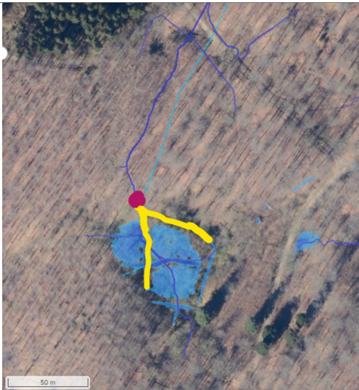
Figur B4.2 – Effektområde for H11 ved skybrud. Arealet dækker 0,34 ha. Kisten afproppes (lilla prik). Ca. 110 meter fordelt på de to grøfter blive tilkastet, for at opnå effekt ved en skybrudshændelse. Den stiplede lyseblå linje viser det §3 beskyttede vandløb, som i dag er rørlagt. Billede fra SCALGO.
