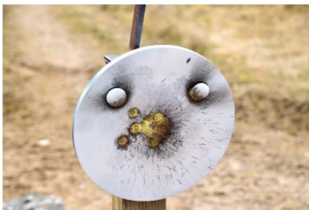
Billede 1: Stålmål efter en af undersøgelsens 10-skudsserier. Målet er "løst fastspændt" i beslag på træstolpe. Foto: Bo Madsen, Sweco Acoustica
