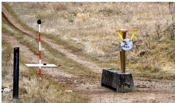
Billede 2: Måleopstilling til støjmåling på stålmål ophængt i stropper. Til venstre for stålmålet ses 2 af undersøgelsens 7 mikrofoner på landmåler stok og på plade. Mikrofonerne omgiver målet og opsat efter "NordTest Method NT ACOU 099 Shooting Ranges: Prediction of Noise". Foto: Bo Madsen, Sweco Acoustica
