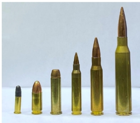
Billede 2: Til undersøgelsen anvendes et bredt, repræsentativt udvalg af kalibre til sports- og tjenesteskydning. Fra venstre: .22 lr, 9 mm, .357 magnum, .223 Remington, .308 Winchester, .338 Lapua Magnum.
