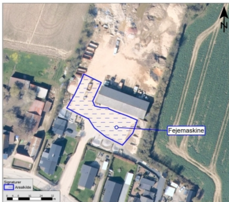
Figur 7-2 Oversigtskort over virksomhedens indretning samt placering af støjkilde for fejmaskine. Kilde for baggrundskort: dataforsyningen.dk.
