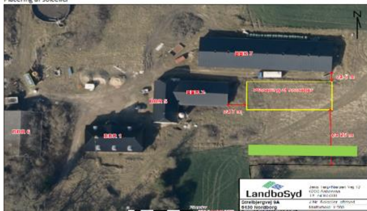
Figur 1. Den afskærmende beplantning placeres i skel syd for anlægget, således at det skærmer for indblik fra det åbne land, uden at skygge for solen.
