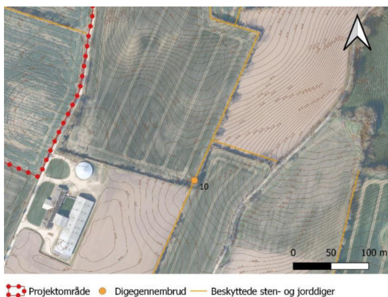
Figur 4-54 Oversigtskort med markering af principiel placering af digegennembrud nr. 10. Digegennembrudet ligger uden for projektområdet og foretages grundet anlæg af midlertidig vejforbindelse, og reetableres efter anlægsperioden. Vejføring af midlertidig vejforbindelse fremgår af Figur 1-11.
