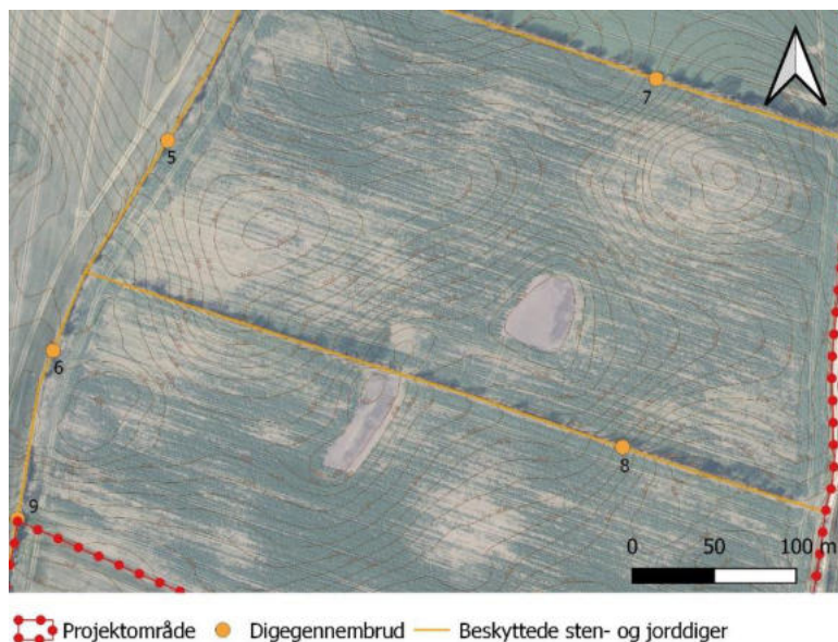
Figur 4-53 Oversigtskort med markering af principiel placering af digegennembrud nr. 5, 6, 7, 8 og 9 for at sikre intern færdselsmulighed inden for projektområdet. Ved digegennembrud nr. 5 rummer diget kun meget lav vegetation, mens digegennembrud nr. 7 og 8 rummer højere vegetation i form af buske og mellemstore træer. Digegennembrud nr. 9 rummer ligeledes mellemstore træer og buske, og foretages grundet anlæg af sti.
