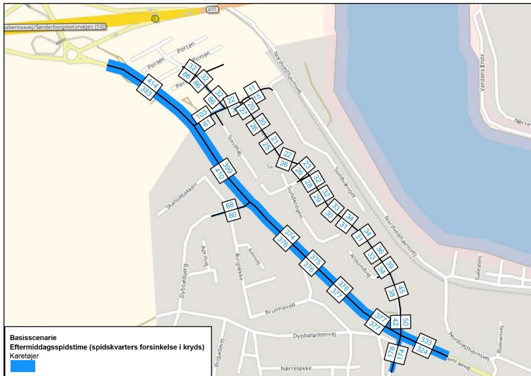
Figur 11. Trafik i basisscenariet for eftermiddagsspidsstimer. Forsinkelser på strækninger og i kryds er tilsvarende spidskvarteret.
