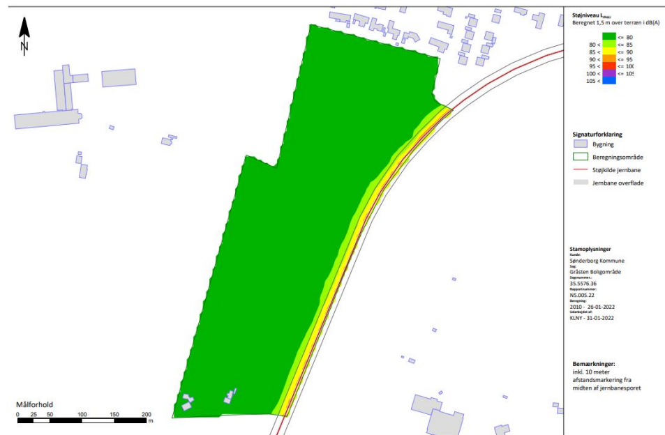
Figur 6.14: Støjudbredelseskort for maksimalstøjniveau fra jernbanen, uden støjafskærmende tiltag. Støjpåvirkninger visualiseret med mørke- og lysegrøn repræsenterer en acceptabel støjpåvirkning jf. gældende grænseværdi, mens resterende farver overgår grænseværdien.
