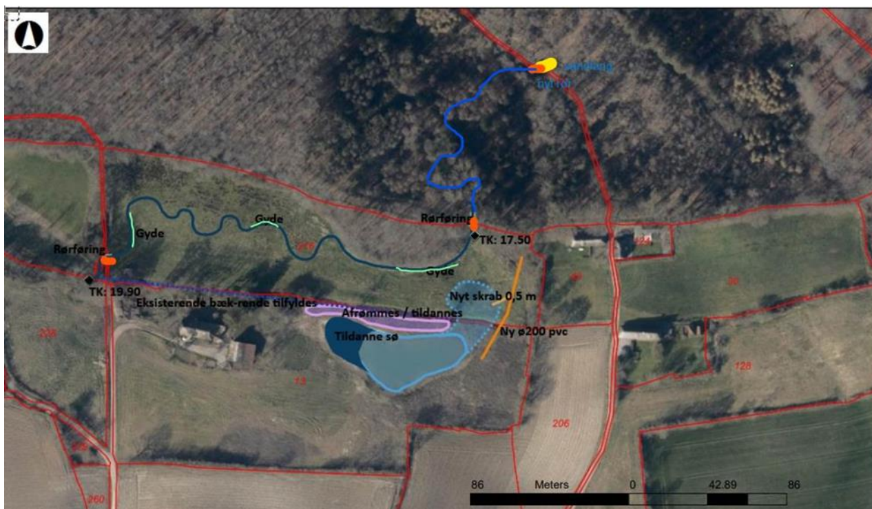
Figur 5: Trace af nyt vandløbsprofil i det lysåbne areal.
