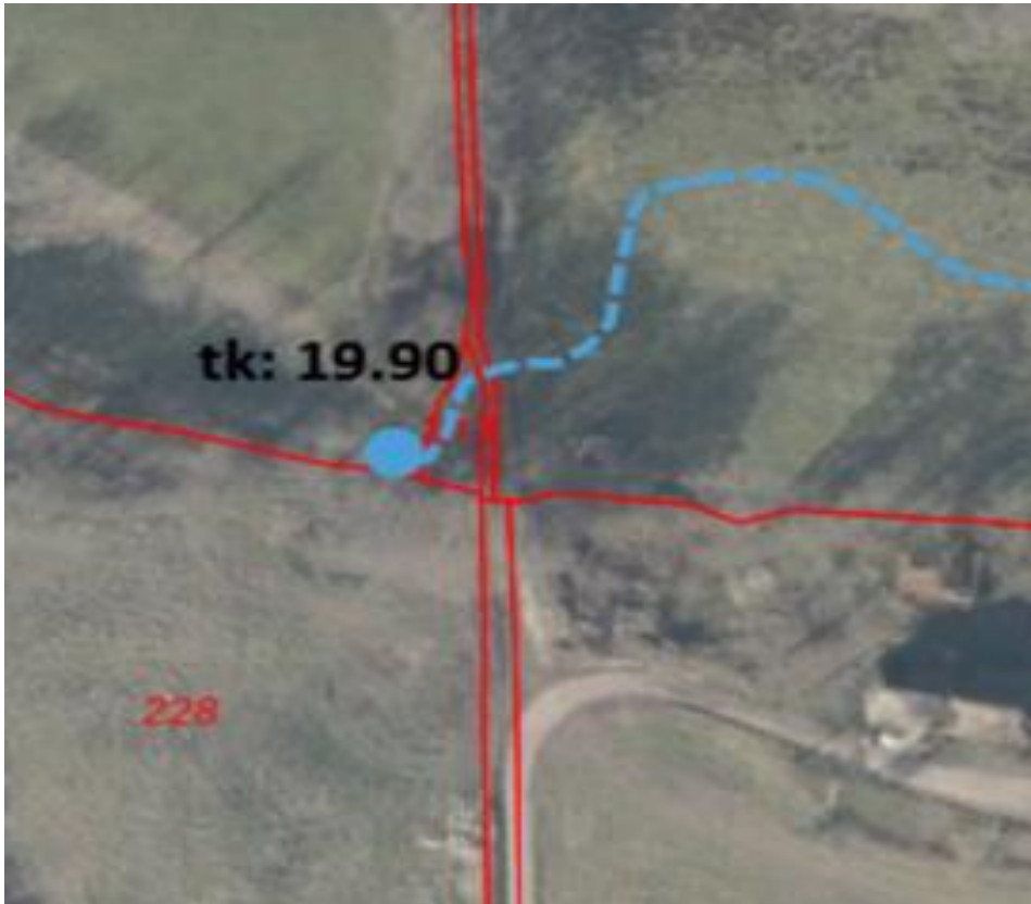
Figur 2: Trace hvor vandløbet ledes ud af eksisterende profil og under sti.
