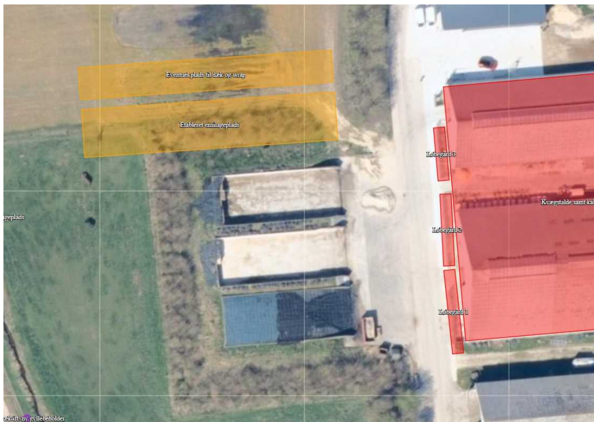
Figur 2. Oversigt over eksisterende ensilagepladser og ny ensilageplads samt asfaltplads
