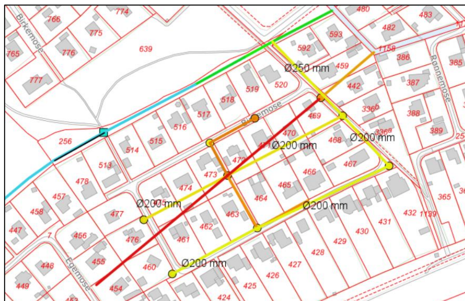
Figur 1. Matrikelkort med udklip af projektets regulering af drænledninger. Den grønne linje viser eksisterende grøft med rørunderføring under vejen Birkemose. Den lyseblå linje viser den ønskede forlængelse af grøften med tilhørende vold og rørunderføringer under stierne (lyseblå firkant). De gule linjer viser anlæggelse af nye drænledninger med tilhørende brønde med sandfang (gule cirkler). Orange linjer og cirkler viser eksisterende hoveddrænledninger og brønde, som bibeholdes. Den røde linje viser eksisterende drænledning, som sløjfes.
