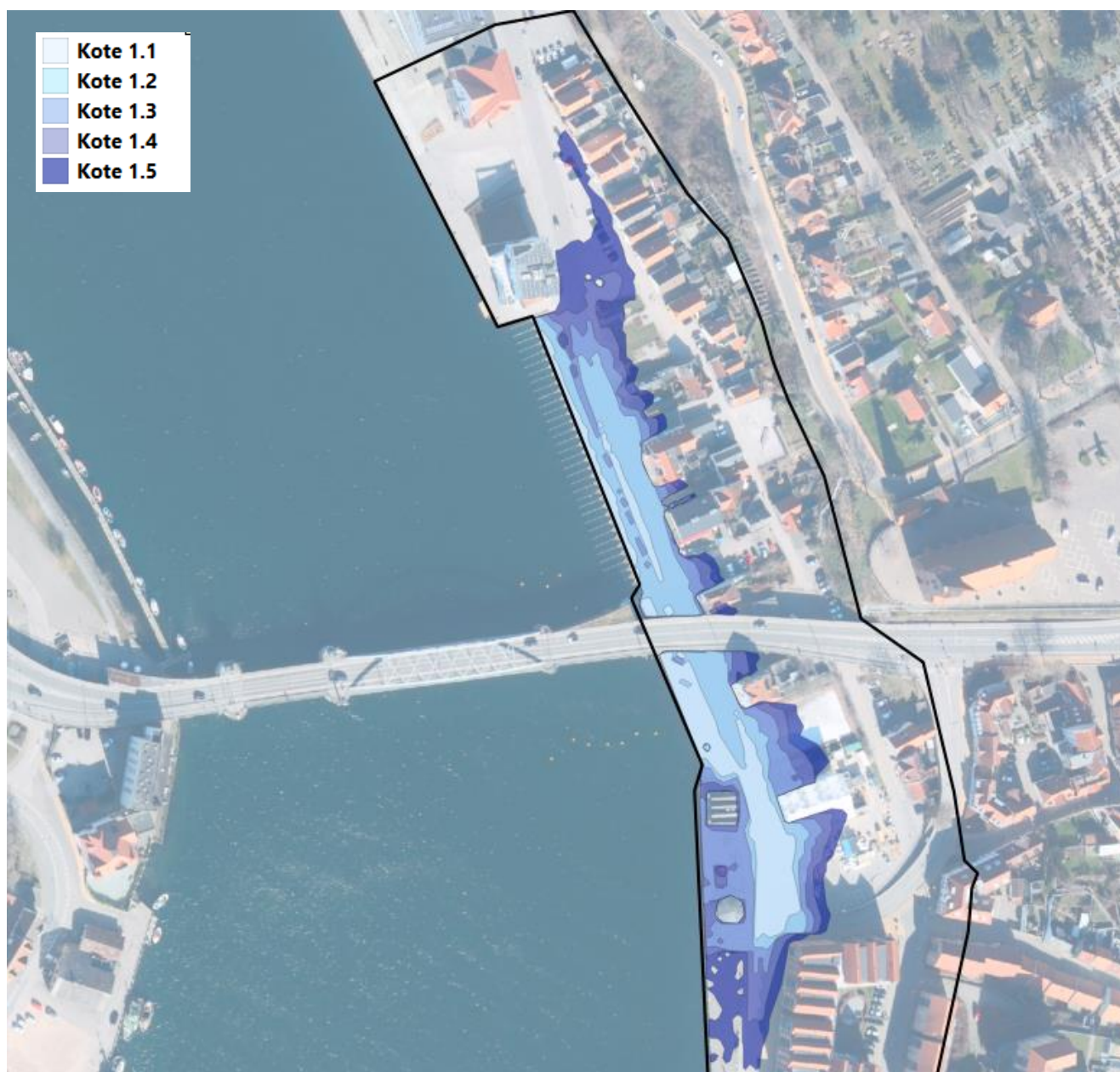
Figur 2.2: Områder der oversvømmes på østsiden af Alssund under Kong Christian den X's Bro ved vandstande i kote 1,1, 1,2, 1,3, 1,4 og 1,5 m DVR90.
